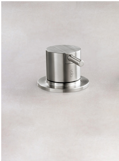
2500 Monoknop bladmengkraan met keramisch cartouche voor hoger debiet. Kraangat: 42 mm. Aansluiting: 10 mm (flexibele slangen).
